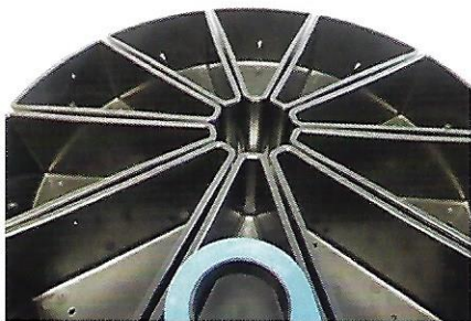
Bild 1: Der Ringsensor überwacht die Teilezufuhr in dem jeweiligen Behälter
